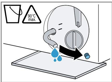
8. Appuyez sur le bouchon de fermeture.
