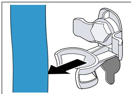
2. Dévissez les 4 vis des sécurités de transport à l'aide d'une clé à vis de calibre 13 ① et retirez-les ②.
