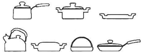
**Om correct te functioneren, moeten alle pannen een vlakke magnetische bodem (een magneet moet hieraan blijven kleven) hebben. Gebruik voor het beste resultaat uitsluitend koekenpannen en pannen met een doorsnede van 12 to 24 cm.**
